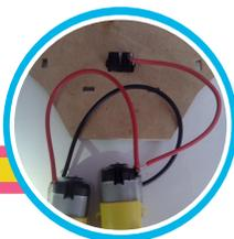
**8** Conecta el cable rojo del portapila de 9 V a la terminal libre del mini *switch*.
